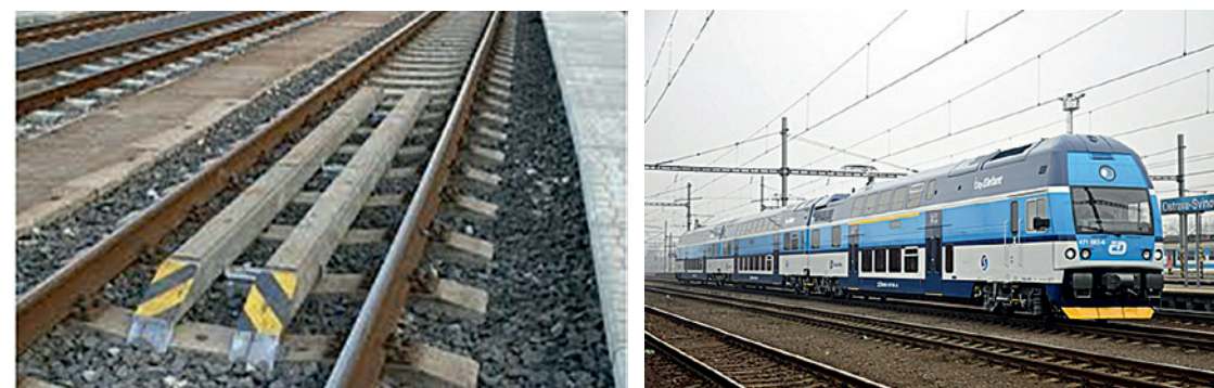
Vlevo: traťová část automatického vedení vlaku (magnetický informační bod), foto: www.fsc.cz
