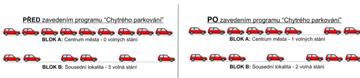
Obrázek 8: Ukázka dopadu parkovací politiky postavené na sledování poptávky s velmi pozitivními výsledky prokázanými v San Francisku, kde byl nasazen sensorový systém SF Park na významné ploše města
