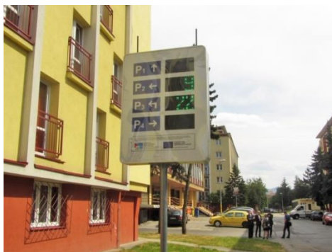
Obrázek 19: Informační tabule obsazenosti parkovacích míst umístěná na vjezdu do zóny, informace předcházejí zbytečnému kroužení
