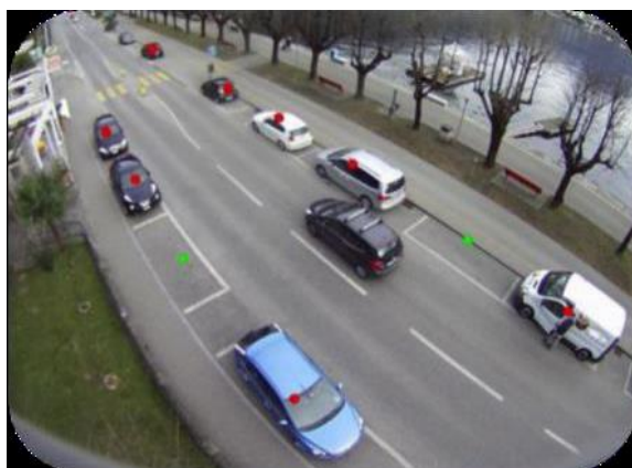
Obrázek 11: Ukázka systému na bázi kamer (produktový list společnosti Designa, s.r.o.)
