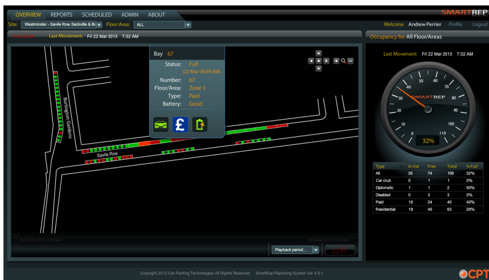
Obrázek 9: Ukázka ze systému ve Westminsteru, kde je vybaveno cca 3500 parkovacích míst detektory s RFID čipem, který komunikuje s konkrétním vozidlem vybaveným parkovací kartou s čipem
