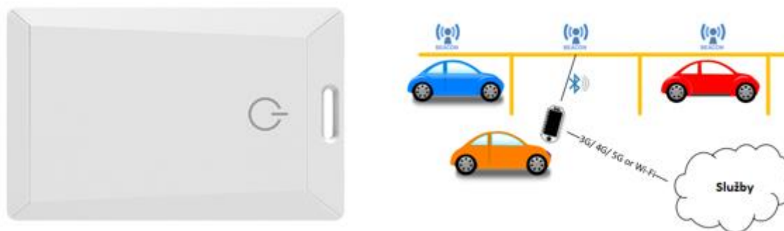
Obrázek 8: Použití iBeaconu pro identifikaci uživatele
