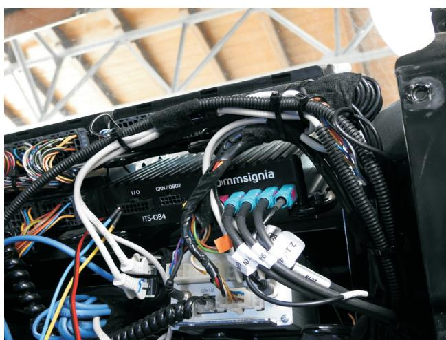
Obr. 10 Instalace RVU do odtahového vozidla
